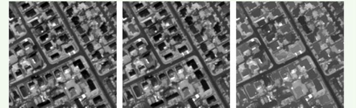
**Illustration 2** : réhaussement de structures linéaires dans le but de détecter les routes en télédétection.
